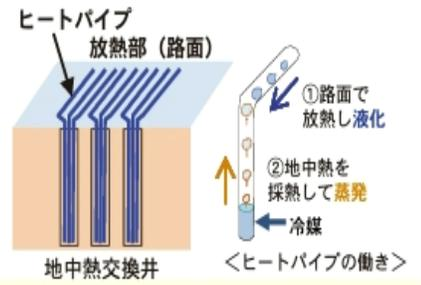
冷媒の蒸発と凝縮で熱を移流させるシステムで、深さ15~20mの熱交換井に冷媒が封入されたヒートパイプを数本挿入し、その上部を路面下に放熱管として埋設する。
