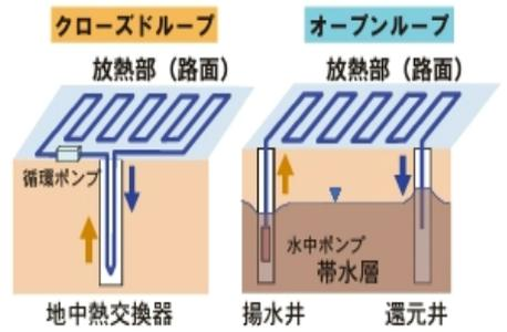
**クローズドループ(地中熱交換)方式**は、地中熱交換器に熱交換器を挿入し、これと路面に埋設した放熱管との間に不凍液等を循環させ、路面の融雪・凍結防止を行う(放射冷房等、融雪以外の利用例もあり)。
