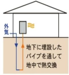
地中に埋設した熱交換パイプ、あるいはダクトに外気を導入・通気し、熱交換された空気を室内に取り込む。
