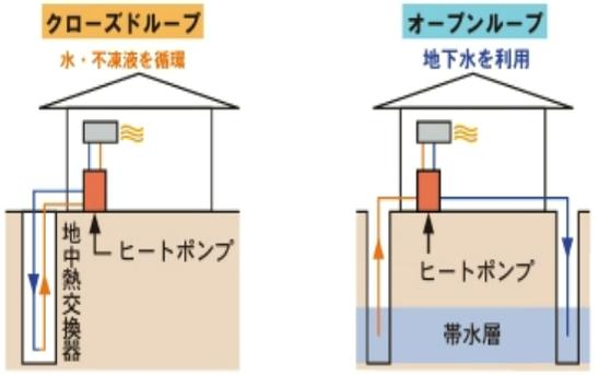
ヒートポンプの熱源として空気熱の代わりに地中熱を利用する方法。
