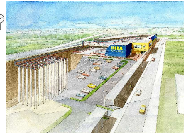
駐車場に深さ100mの地中熱交換器を70本掘削した。 [イメージ図]
