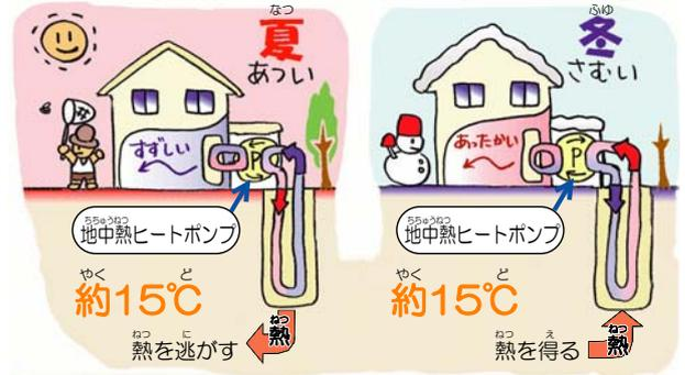
図2 地中熱ヒートポンプシステム
