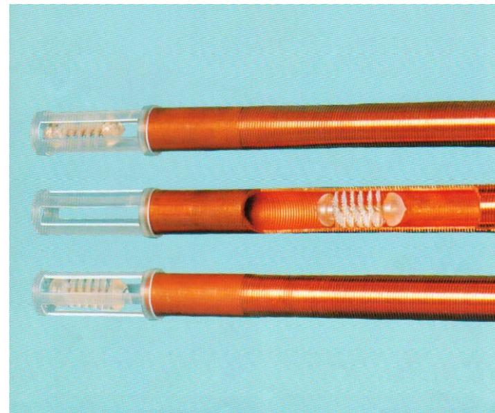
起動時及び停止時に四方弁を動作させ、逆洗をおこない、チューブ内面に付着したスケール・スライムを除去
