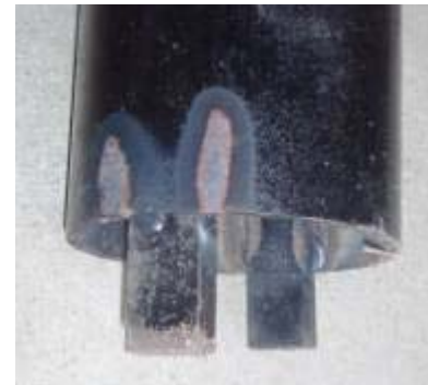
ストレート鋼管先端開放
