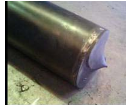
ストレート鋼管先端閉塞
